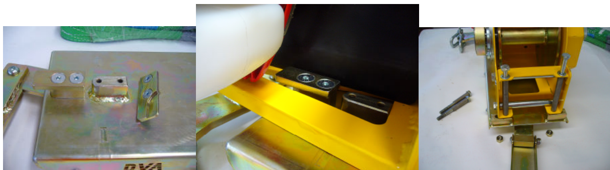
Figura 5 : Montaggio verricello VA720 su G.MAXI
