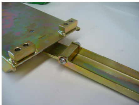
Figura 2 : Montaggio barra guidafune
