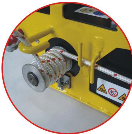
Figura 4 : Avvolgimento della fune sul tamburo
